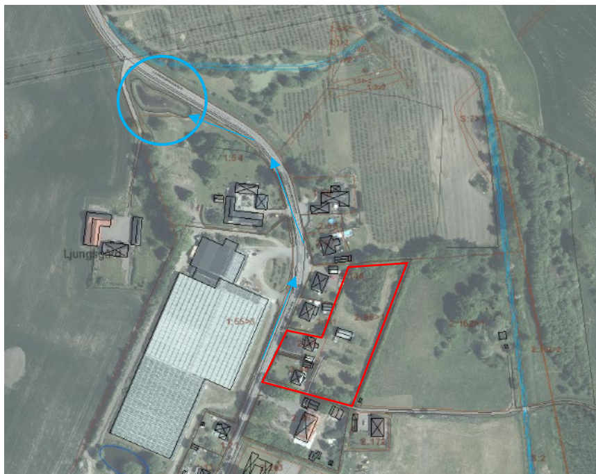
Planområdets placering i förhållande till befintlig dagvattendamm. Blå pilar visar dagvattnets väg.
